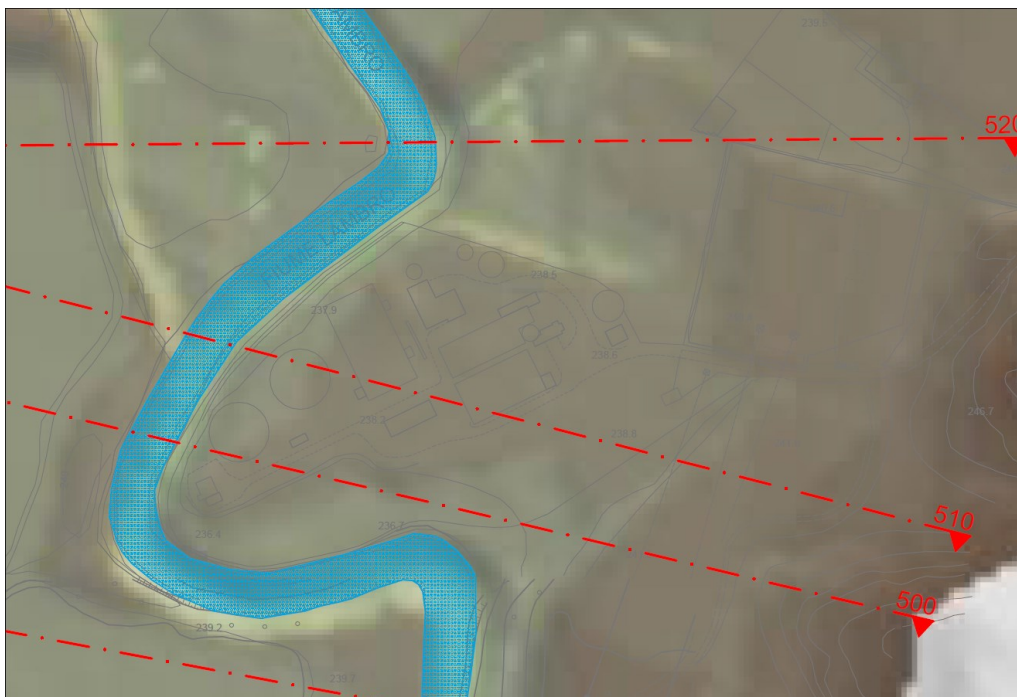
Figura 4 - Stralcio planimetrico che evidenzia l'andamento plano-altimetrico dell'area del depuratore da DTM nella situazione attuale (Rif. Tavola T.02 Rilievo topografico e DTM stralcio di monte del progetto definitivo dell'area di laminazione di Inverigo).
